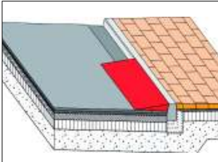
Ein Bitumenkeil ermöglicht den Übergang vom Gehweg auf die Fahrbahn und umgekehrt.
