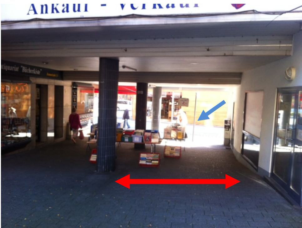
Blickrichtung von Westen nach Osten (Durchgangsbreite ca. 2,00m; Anordnung der Warenauslage muss optimiert werden, sodass eine Durchgangsbreite von mind. 2,50m zwischen Säule und rechter Hauswand erzielt wird)
