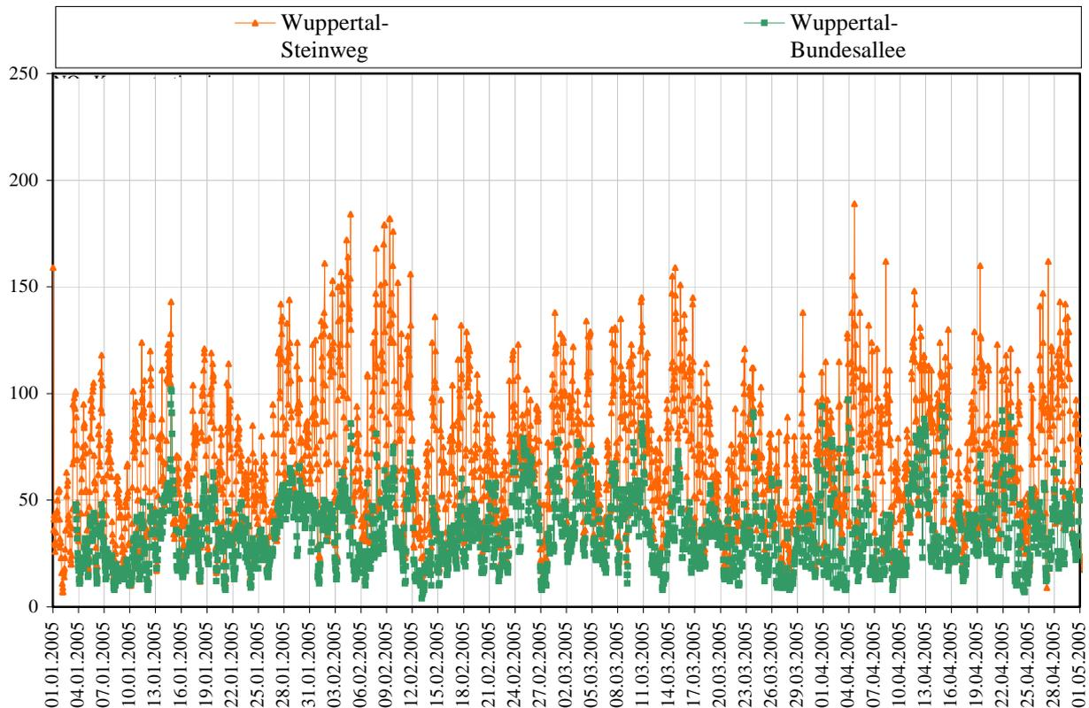
Abb. 11: Verlauf der NO<sub>2</sub>-Stundenmittelwerte (µg/m<sup>3</sup>) an den beiden kommunalen Messstellen *Steinweg* (Hot-Spot) und *Bundesallee* (Hintergrund)
