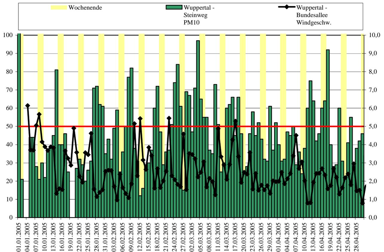
Abb. 10: Gegenüberstellung Feinstaub-Tagesmittelwerte ( $\mu\text{g}/\text{m}^3$ ) am *Steinweg* mit den Tagesmittelwerten der Windgeschwindigkeit ( $\text{m}/\text{s}$ ) an der *Bundesallee*
