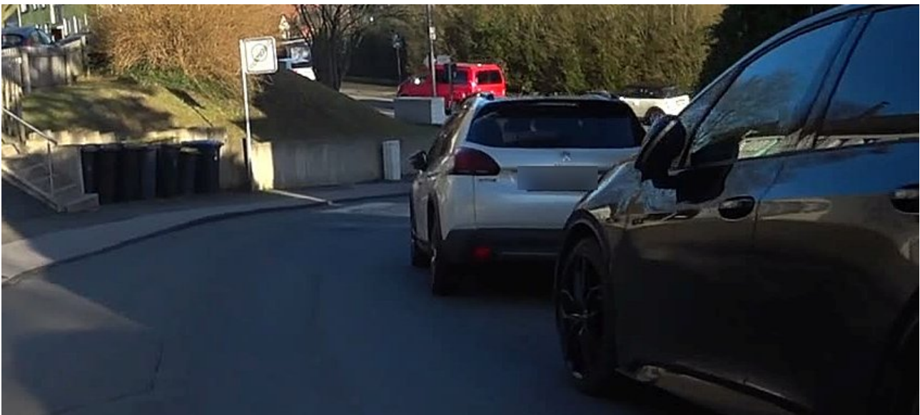
Bild 3: Ausfahrt zur Opphofer Straße. Die Sichtbeziehung entgegenkommender Verkehre ist durch die auf der Kurveninnenseite parkenden Fahrzeuge sehr eingeschränkt bis gar nicht möglich.
