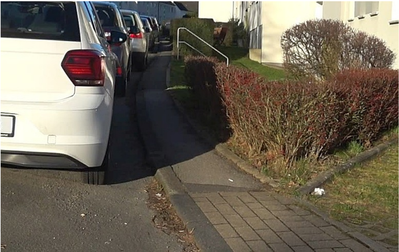
Foto 2: Der Gehweg auf der Südseite ist lediglich ~40 cm breit. Der Zugang zu den Häusern wird durch direktes Zuparken der Zuwegung wesentlich erschwert.
