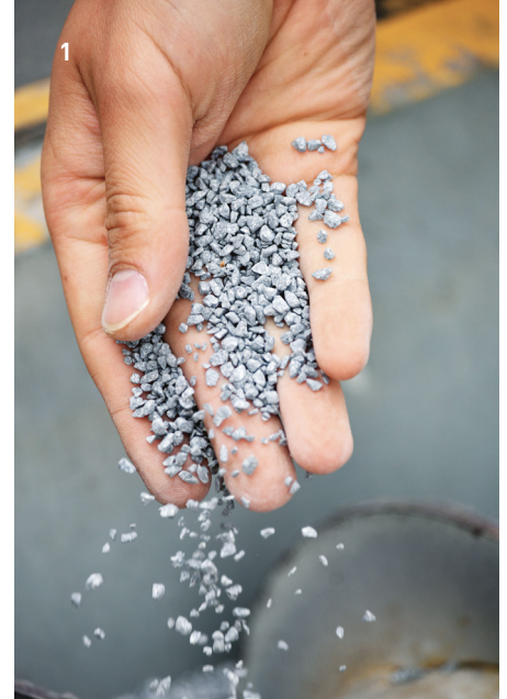
1 Abstreugranulat aus mit Titandioxid versetztem, ultrahochfestem Beton © STRABAG AG
