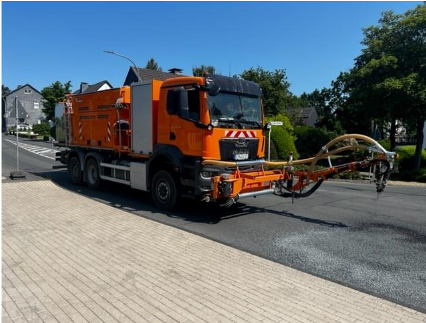
Foto 3: Modernes, neuwertiges Patchmatikfahrzeug im Einsatz mit Einhandbedienung (Anschaffungswert: ca. 500.000 €)
