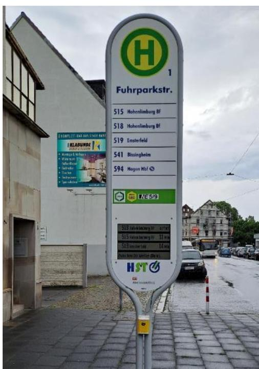
stark frequentierten Haltestellen durch große Übersichtsanzeigen beziehungsweise eigenen Anzeigen an den Abfahrtspositionen. Eine weitere Option stellen kleinere Anzeigen dar. Diese werden in die ohnehin erforderliche Infrastruktur einer Haltestelle integriert (DFI light). Auch DFI-light erfüllt die Anforderungen an die Barrierefreiheit. Die optische Anzeige der nächsten Abfahrten kann durch eine Vorlesefunktion ergänzt werden.
