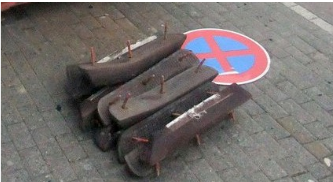
Bild 3: defekte Leitborde Ende 2016
