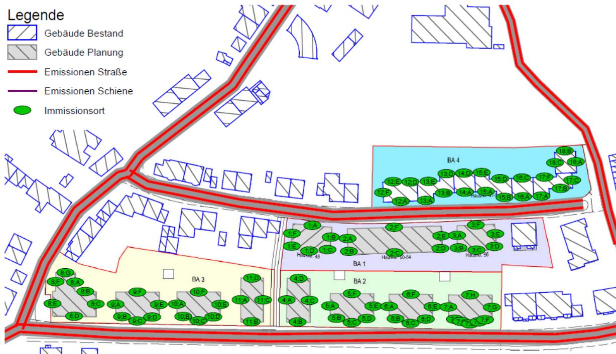
Abb. 6: Darstellung des digitalen Simulationsmodells "Verkehrslärm im Plangebiet" mit Kennzeichnung der berücksichtigten Immissionsorte (Quelle: Peutz, s. Kap. 13)
