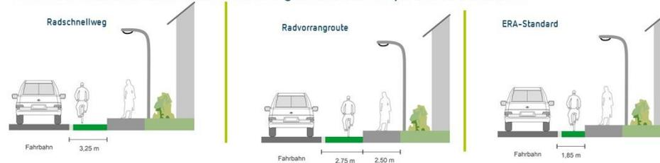
**Zweirichtungsverkehr, getrennter Geh- /Radweg, außerhalb, selbstständig geführt**
