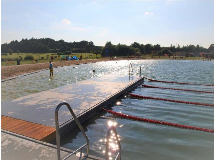
Abbildung 13: Trennendes Deck als beidseitiger Anschlag der 25 m Bahnen. Hier Bauart Tessin, in Betonausführung
