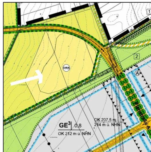
Abbildung 5 Festsetzung eines Regenrückhaltebeckens im Bebauungsplan Nr. VIII / 73 "Langes Feld" der Stadt Kassel (Quelle: Stadt Kassel 2012)
