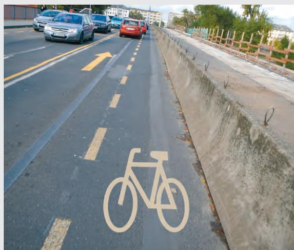
Bild 9 | Schutzstreifen statt Führung in reinem Mischverkehr auf der Fahrbahn
