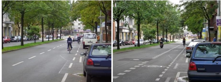
Für bestehende zweistreifige überbreite Fahrbahnen ist die Reduzierung der Fahrbahnbreite zum Beispiel durch die Markierung von Radfahr- oder Schutzstreifen möglich (Beispiel Neumühler Straße, Oberhausen in Abbildung 9).
