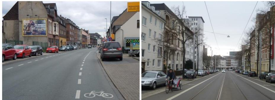
In Straßen mit Gefällstrecken oder bei beengten Platzverhältnissen kann auch eine einseitige Radverkehrsanlage eine sinnvolle Maßnahme sein. Darüber hinaus kann mit weiteren linearen oder punktuellen straßenräumlichen Maßnahmen die tatsächliche oder optische Fahrbahnbreite reduziert und ein angepasstes Geschwindigkeitsniveau unterstützt werden.
