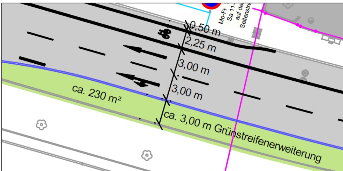
**Abbildung 3: Fahrbahnquerschnitt FR Westen im Bereich der Bebauung**
