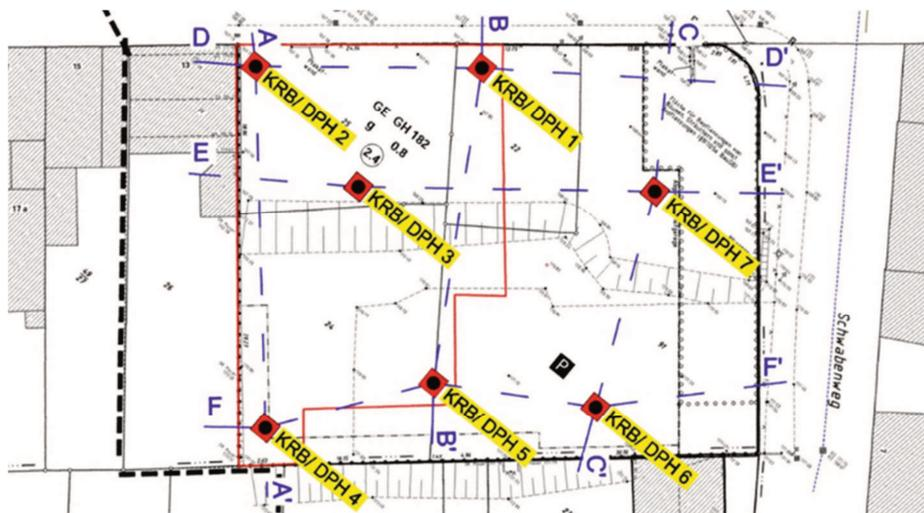
Abbildung 15: Auszug aus dem Lageplan zum geotechnischen Bericht mit Darstellung der Kleinrammbohrungen<sup>16</sup>
