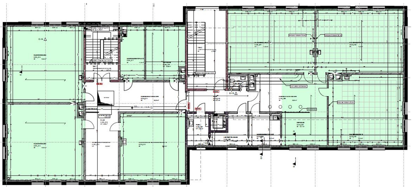
Übersichtsplan Statik, grün markiert sind die Deckenbereiche, welche als Hohlspanndecken ausgeführt werden
