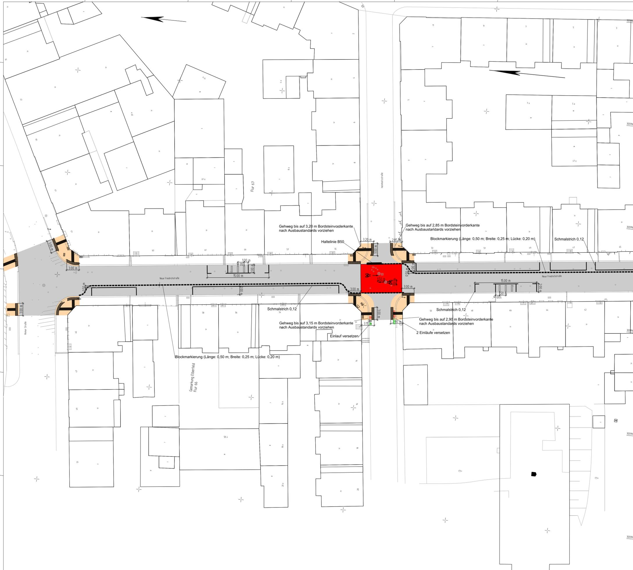
Die taktilen Elemente sind nach den Standards der Stadt Wuppertal / 104.52 zu gestalten. An allen Querungen ist der Bord auf der gesamten Länge (3,00 m) bis zu einer Auftrittshöhe von 3 cm abzusenken.
