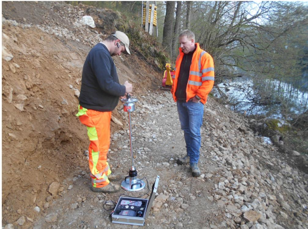
Kontrolle der Verdichtung mittels Dynamischem Fallplattendruckversuch
