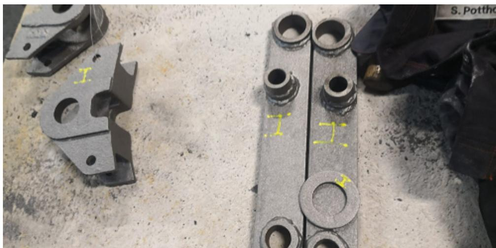
Weitere ausgebaute und beschriftete Teile der Bremsanlage des SKL-Anhängers
