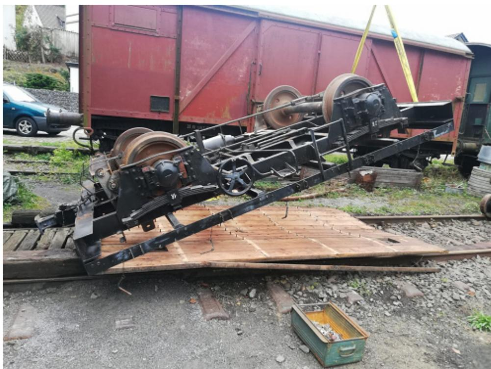
Beginn Abbau des Bodens und Vorbereitung zur Demontage der Bremsanlage
