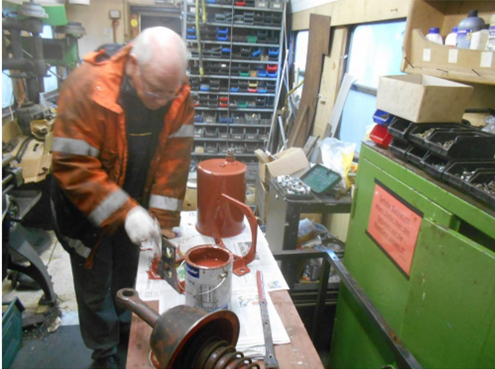
Lackier- bzw Grundierarbeiten am ausgebauten Bremszylinder des Wagens.
