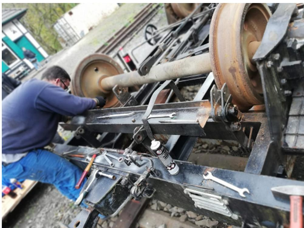
Ausbau der Bremsklötze sowie des kompletten Bremsgestängen
