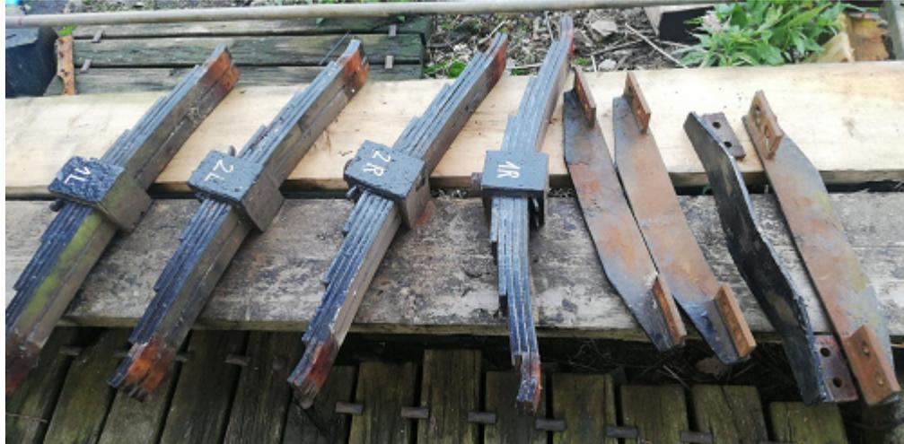
Blattfedern der Achsen nach dem Ausbau. Alle Bauteile werden komplett beschriftet, damit ein Zusammensetzen später wieder einfach möglich
