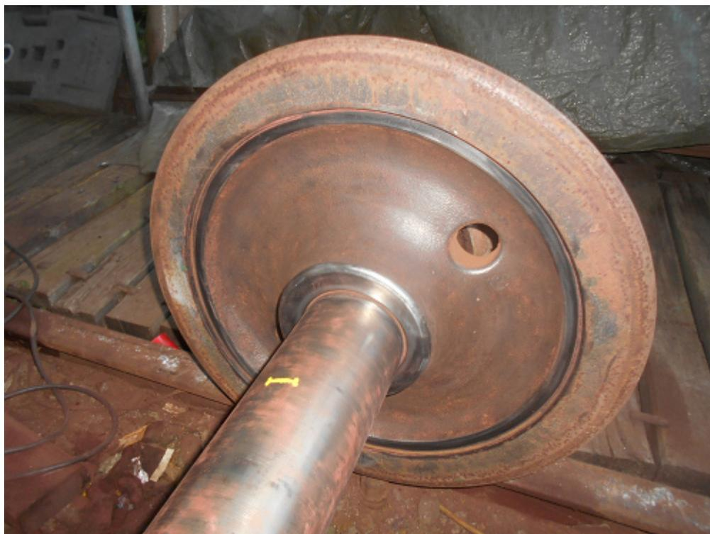
Als Vorbereitung einer Materialprüfung mittels Ultraschall wurde die ganze Achse komplett von Altlack befreit. Auch der gesamte Rost wurde entfernt.
