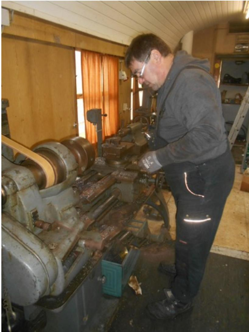
An der vereinseigenen Drehbank werden werden die Bolzen für das Bremsgestänge nachgedreht und zum Einbau angepasst
