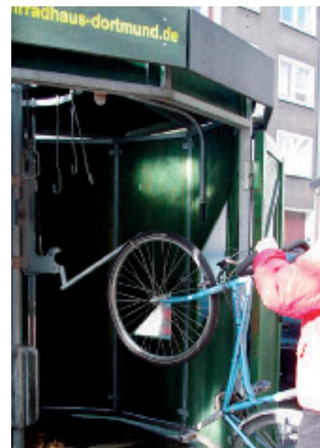
Das Einhängen des Fahrrads macht in der Regel kein Problem. Für diejenigen, denen das Anheben des Fahrrads zu schwer ist, gibt es einen Lift mit einer Gasdruckfeder; diese Hilfe eignet sich auch für E-Bikes.
