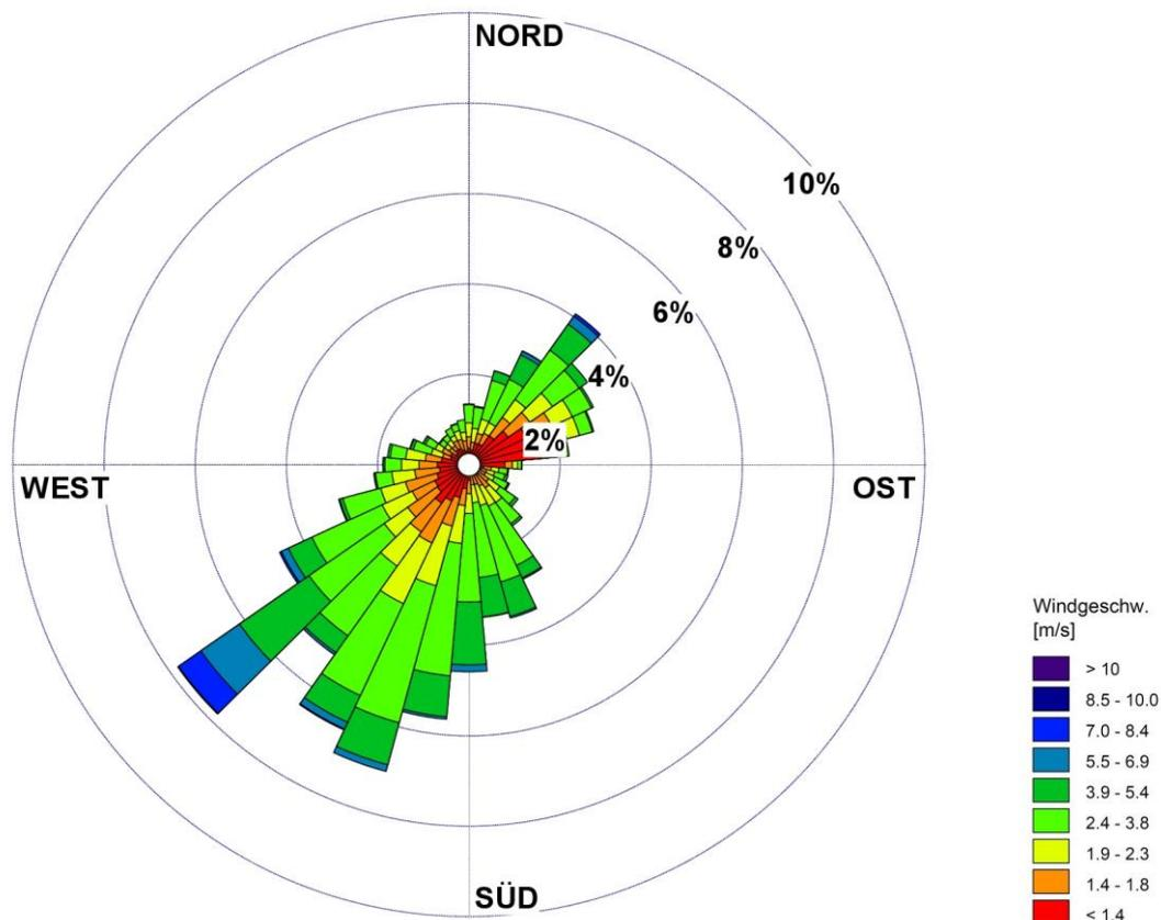
Abbildung 6 Stärkewindrose (Häufigkeitsverteilung der Windrichtungen) in Abhängigkeit der mittleren Windgeschwindigkeit) an der Messstation Wuppertal-Bundesallee im Messzeitraum 01.01. bis 31.12.2014.
