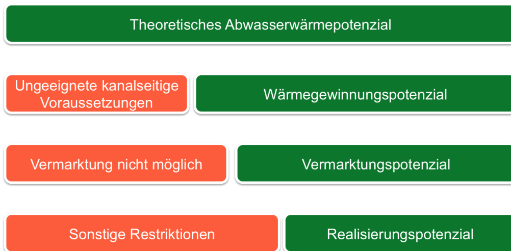
Abbildung 28: Potentiale Abwasserwärme (Eigene Darstellung nach BECKER)
