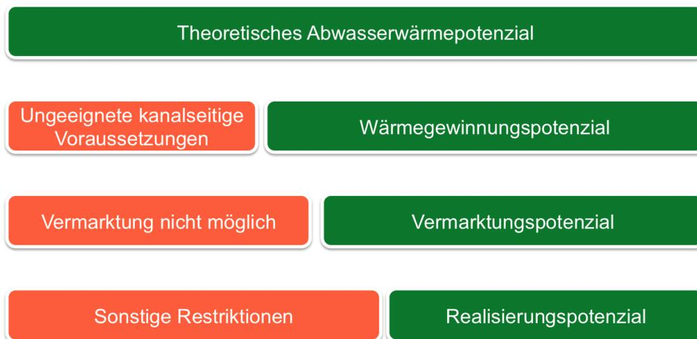
Abbildung 28: Potenzielle Abwasserwärme (Eigene Darstellung nach BECKER)
