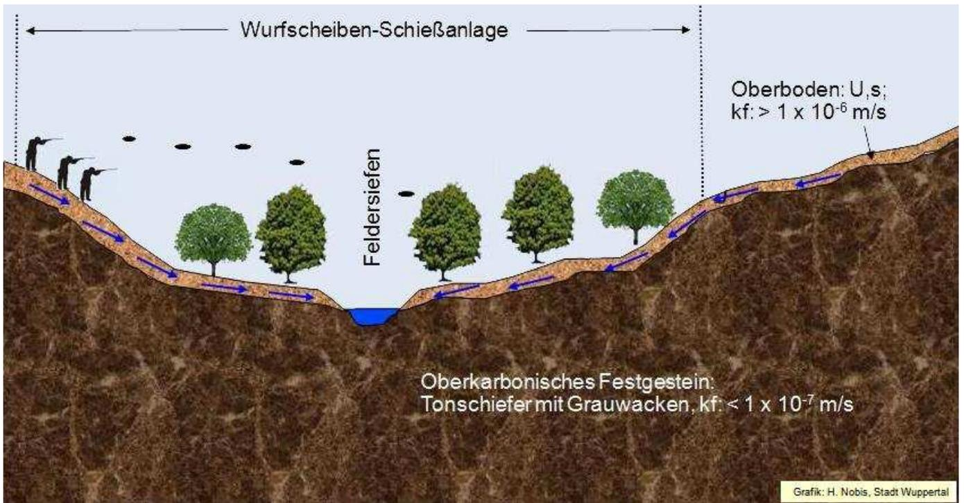
Anlage 2 zur Drucksache VO/0019/13: Schematische Darstellung der Wurfscheiben-Schießanlage Mollenkotten
