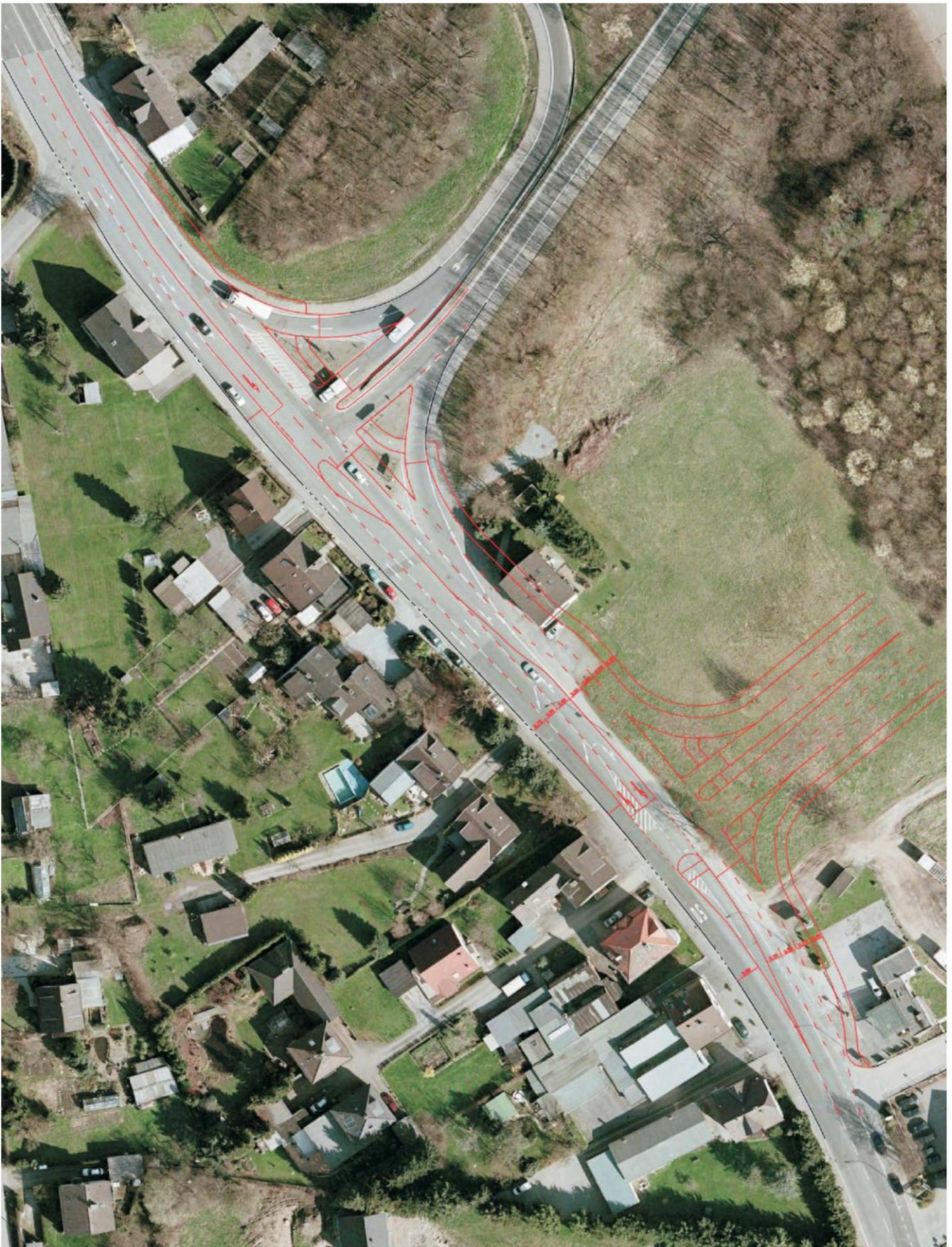
Abbildung 5: Lageplan zur Umgestaltung des Knotenpunktes 3 & Neuanlage des Knotenpunktes 4; Quelle: INGENIEURBÜRO FÜR VERKEHRSWESEN KOEHLER & LEUTWEIN (08/2012)
